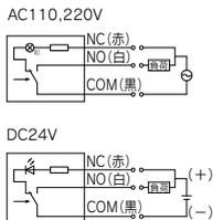
図中の矢印は圧力上昇方向を示します。ランプは設定圧力以上で消灯し設定圧力以下になると点灯します。
