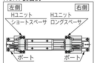
※スぺーサは、ストローク調整ユニットをストロークの中間位置で固定するための取付金具です。
