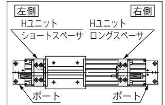
※スペーサは、ストローク調整ユニットをストロークの中間位置で固定するための取付金具です。
